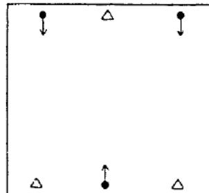
(b) ドーム形天井等を有する防火対象物に感知器を設置する場合にあっては、当該感知器の光軸が、ドーム形天井等の各部分の高さの80%内に收まり、かつ、未監視区域を生じないように設置すること。
