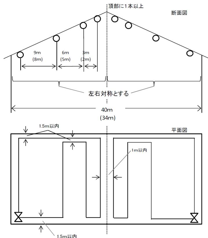
(イ) 相対する感知器の相互間隔は 6 m (主要構造部を耐火構造とした防火対象物又はその部分は 9 m) 以下とすること。
