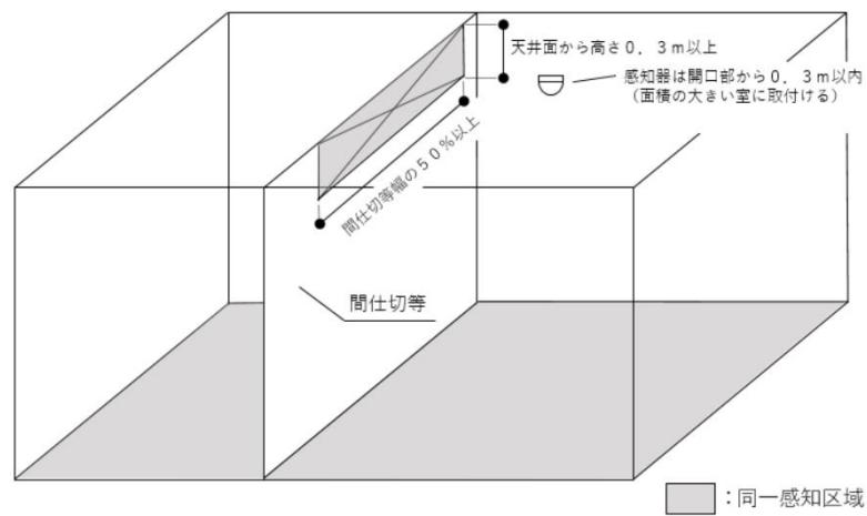
カ 煙感知器の感知区域を構成する間仕切壁の上方（取付け面の下方0.6m未満）の部分に空気の流通する有効な開口部（取付け面の下方0.2m以上×1.8m以上の間隙）を設けた場合は、隣接する2以上の感知区域を1の感知区域とすることができる。
