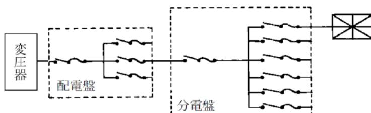
オ 回路の分岐点から3m以下の箇所に各極を同時に開閉できる開閉器及び過電流遮断器（定格遮断電流20アンペア以下のもの）を設けること。
