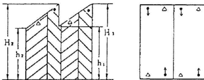
① 軒の高さ ( $h_1, h_2$ ) が天井等の高さの最高となる部分の
