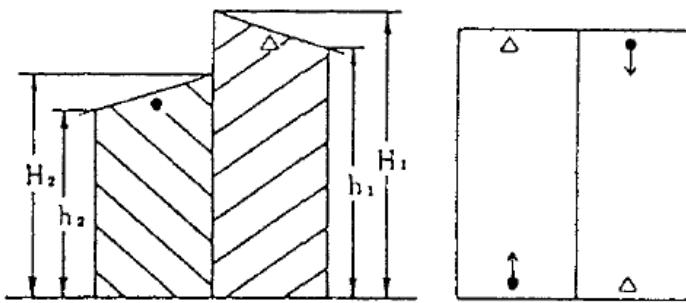
b 越屋根を有する傾斜形天井等における監視区域の設定
