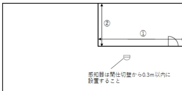
※ 感知器を設置する感知区域に2面(①,②)以上が面する場合、開口部の幅は最長の間仕切り壁(①)の1/2以上とすること。
