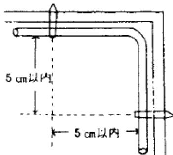
ウ 差動式分布型（熱電対式）の感知器は、規則第23条第4項第4号の2の規定によるほか、次により設けること。
