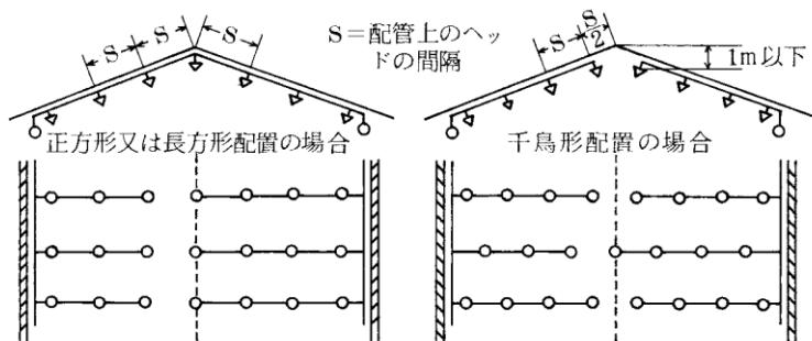
イ ヘッドを取付ける面の傾斜が1分の1 ( $45^\circ$ ) を超えるもので当該屋根又は天井の頂部にヘッドを設ける場合は、次図の要領により当該屋根又は天井とヘッドとの水平離隔距離を60cm以上とすることにより、当該屋根又は天井の頂部からの垂直距離をアによることなく1mを超えて設けることができる。◆
