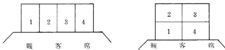
ウ 2以上の放水区域の境界付近において火災が発生した場合に、どちらか一方の放水区域を放水することにより消火が可能であるようにしておくことが必要なため、隣接する放水区域の相互重複は、次によるものとすること。ただし、逆止弁方式のものは、点検困難なため用いないこと。◆
