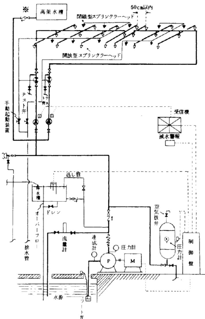
図3-4 開放型スプリンクラー設備の構造図例
